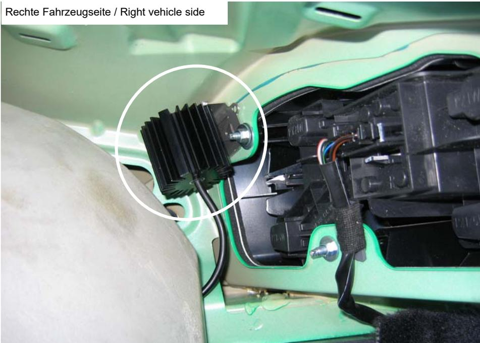
Originale Dämpfersteuerungsleitung in die mitgelieferten Stilllegungen einstecken. Auf die korrekte Verriegelung des Steckers achten! Anschließend originale Dämpfersteuerungsleitung mit Kabelbinder befestigen und die Abdeckung wieder montieren.
